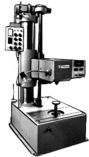
В основании смонтирован привод стола, обеспечивающий поджатие испытуемого изделия при измерении.
