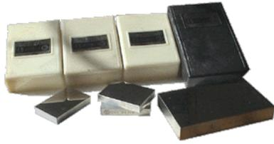
Меры твердости эталонные 2-го разряда по ГОСТ 9031-75 применяются при поверке приборов для измерения твердости металлов по методам Бринелля, Виккерса, Роквелла и Супер-Роквелла.
